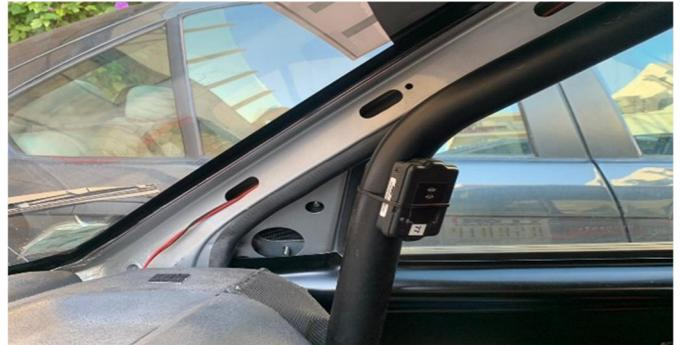
Le boîtier se met en route automatiquement lorsque la voiture est en mouvement, il n'y a pas de bouton pour la mise en marche.
